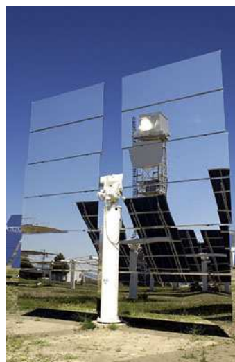
Figura 2: Vista de un heliostato del campo SSPS-CRS reflejando la torre
