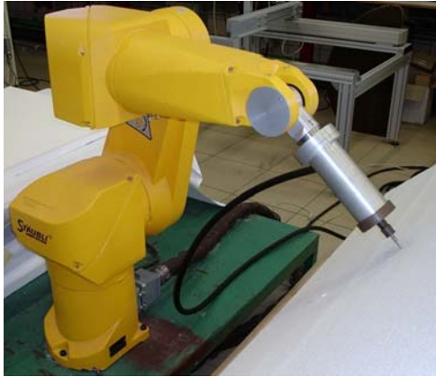
Figura 5: Robot manipulador con la fresadora neumática acoplada.
