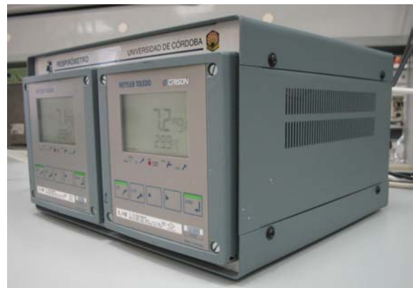
Figura 10. Aspecto general del módulo de acondicionamiento de señal
