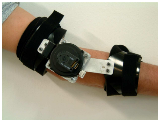
Figura 4: Ortesis con motor ultrasónico utilizada en el proyecto DRIFTS para la cancelación activa del temblor en miembro superior.
