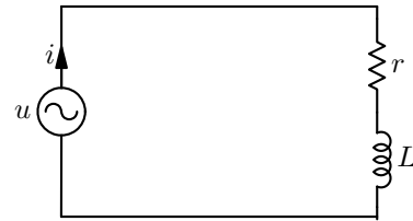
Figura 14: Esquema monofásico del prototipo experimental.
