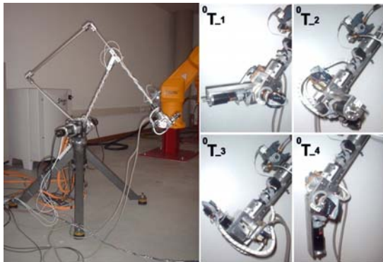
Figura 6. Foto del robot según {}^0T_2 y orientaciones de la muñeca: {}^0T_1 , {}^0T_2 , {}^0T_3 y {}^0T_4 .
