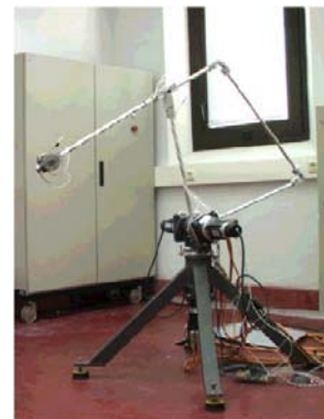
Figura 1. Brazo flexible de 3 grados de libertad
