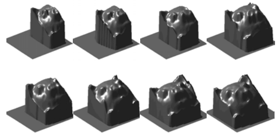
Figura 7. Imagen de intensidad, patrón de color proyectado en un objeto y puntos 3D correspondientes a los puntos del patrón junto a la superficie recuperada (arriba). Detalles de la recuperación 3D en una secuencia de varias tomas (abajo)
