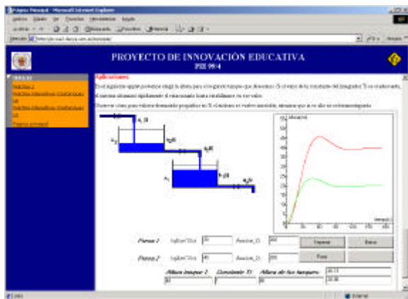
Figura 8. Simulación del problema de los dos tanques.
